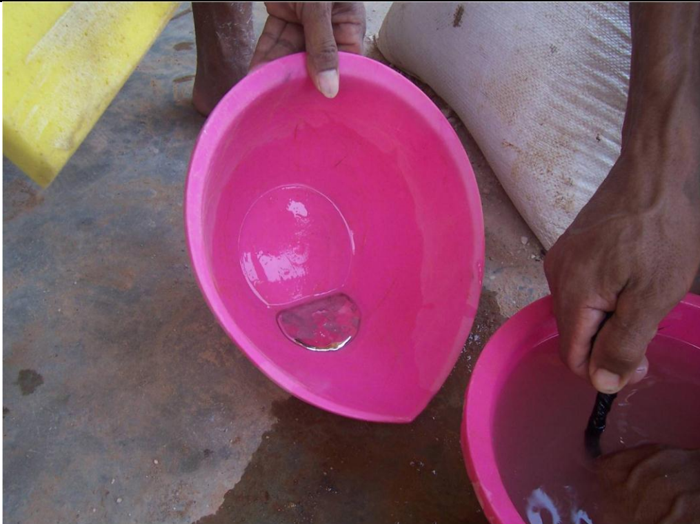
Gambar 5. Sekitar 500 g merkuri ditambahkan ke dalam tiap gelundung, lalu digiling selama 5 jam. Di akhir proses, terbentuklah amalgam yang lalu dibawa ke toko emas untuk dibakar. Foto: Yuyun Ismawati/BaliFokus.
