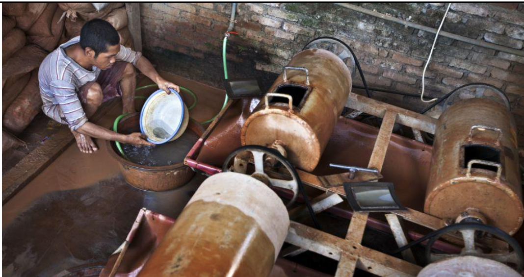
Gambar 8. Air yang dicampur dengan 400-500 gram merkuri dipindahkan ke ember setelah diolah dalam tabung mesin penghancur batu.
