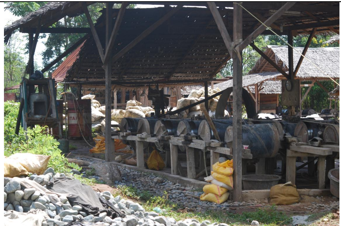
Gambar 4. Saat harga emas tinggi, lebih dari 20.000 gelundung beroperasi 24 jam sehari. Terdapat kurang dari 20 fasilitas yang memiliki izin usaha dan laporan Amdal dari BLH Kota Palu. Pada Juni 2011, konsentrasi uap merkuri yang diukur di wilayah ini mencapai 45.000 ng/m 3 . Foto: Yuyun Ismawati/BaliFokus.
