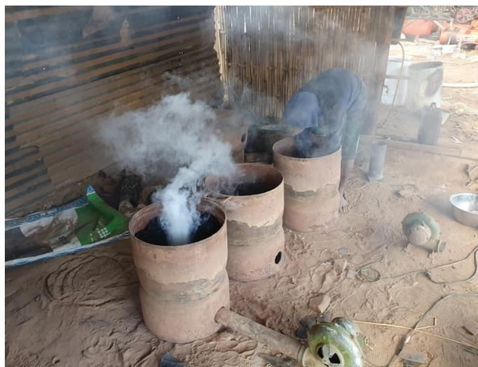
图3 印度尼西亚的汞污染氰化厂。残渣库存, 液体排放物, 含有金、汞和氰化物的焙烧活性炭的排放物。受污染残渣作为建筑材料被送出。(资料来源: IPEN的Lee Bell)
