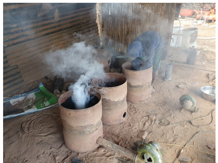
Рис 3. Загрязненное ртутью предприятие по цианированию в Индонезии. Хвостохранилища, жидкие сбросы, выбросы от обжига активированного угля, содержащего золото, ртуть и цианиды. Загрязненные хвосты вывозили для применения в качестве строительного материала. Источник: Lee Bell, IPEN
