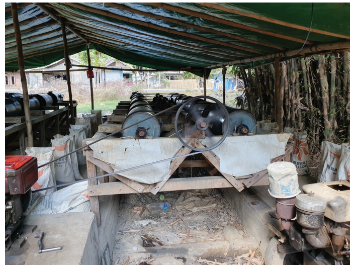
Рис 2. Загрязненный ртутью участок с шаровыми мельницами, Индонезия. Источник: Lee Bell, IPEN
