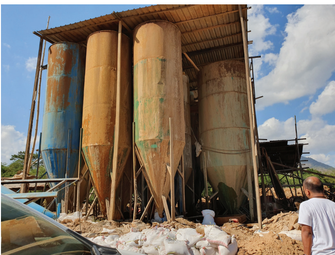
Рис 3. Загрязненное ртутью предприятие по цианированию в Индонезии. Хвостохранилища, жидкие сбросы, выбросы от обжига активированного угля, содержащего золото, ртуть и цианиды. Загрязненные хвосты вывозили для применения в качестве строительного материала. Источник: Lee Bell, IPEN
