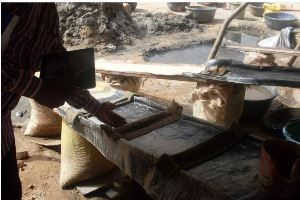
**Photo 6 :** Partie Supérieure d'un Sluice avec rifles (KOMABANGOU)
