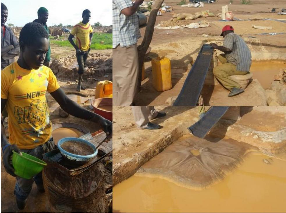
**Photo 5** : Traitement par sluice (Tamou)
