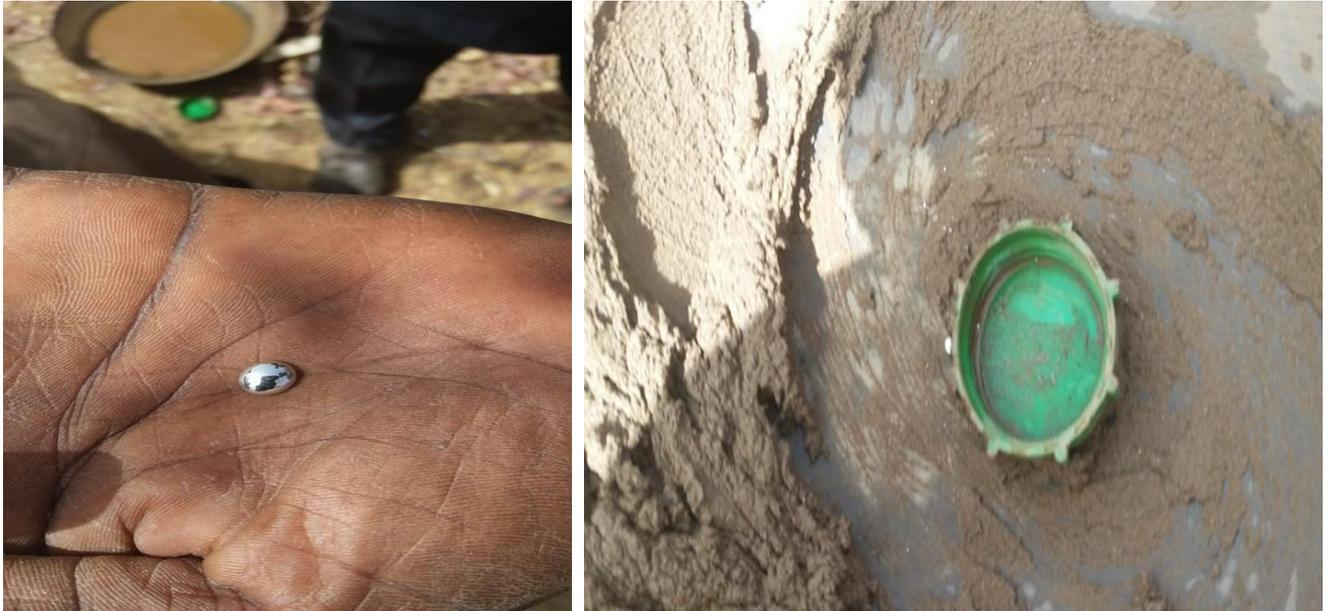
**Photo 8:** Un orpailleur tenant une goutte de mercure dans sa main (Tamou) ; mélange avec le mercure jusqu'à agrégation complète.
