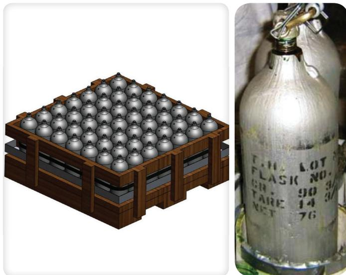
*Figura 1. Ejemplos del envasado de mercurio elemental que se puede almacenar como desechos de manera permanente. Fuente: Departamento de Energía de Estados Unidos (2009)*
