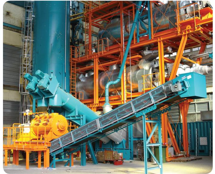
*Figura 4. Unidad de destilación al vacío de calentamiento indirecto. Fuente: econ industries GmbH citado en UNEP/ISWA 2015*
