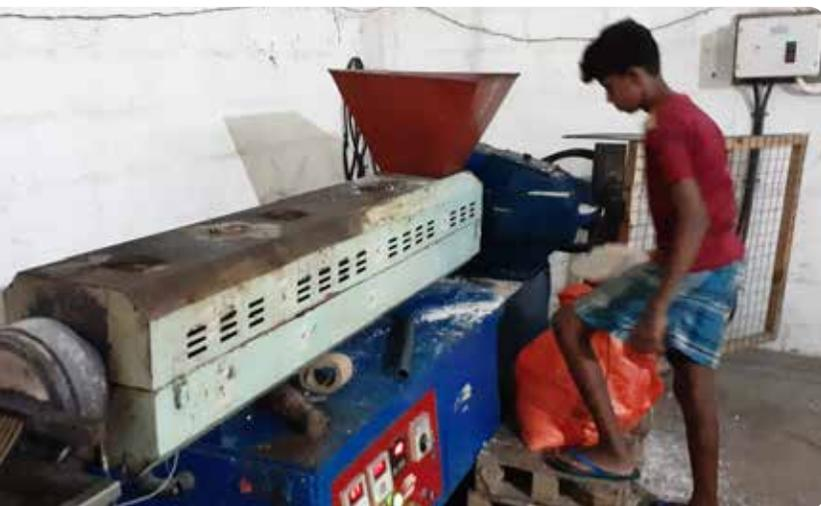
**Les déchets de matière plastique émiettés en train d'être recyclés en granulés de plastique au Sri Lanka.** . Photo: CEJ
