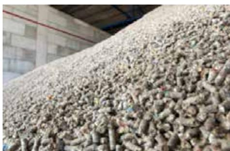
**Figura 24. Pellets de CDR.** Fuente: Nexen Biomass
