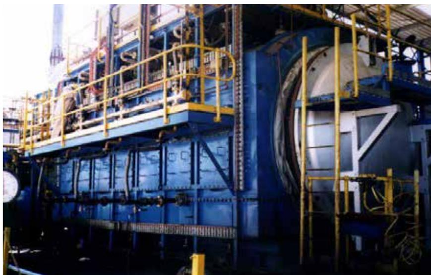
**Figura 33. Procesador de reducción térmica por lotes (PRTL) de la unidad RQFG.** Fuente: Hallett Environmental & Technology Group Inc. 2018
