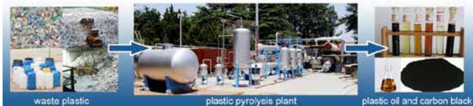
**Figura 20. La conversión del plástico en combustible fósil a través de la pirólisis.**
