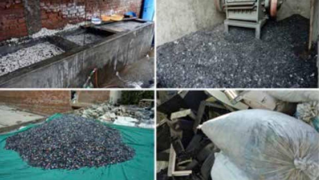
**Figura 10. Molienda, separación por flotación y clasificación por recolectores informales de residuos, India.** Fuente: Haarman y Gasser 2016
