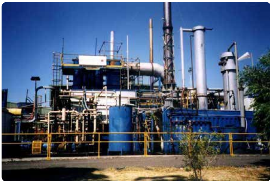
Figura 8. La RQFG funcionando en un ciclo de 24 horas/7 días a la semana para el tratamiento de aceite con PCB de alta intensidad/desechos en Kwinana, Australia, 1999. Fuente: D. Hallett
