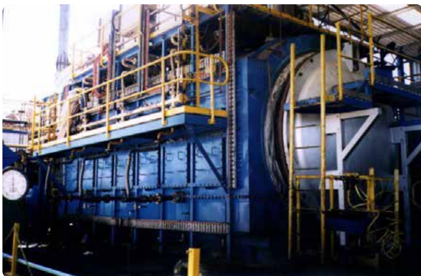
Figura 7. Procesador por lotes de reducción térmica (TRBP) del sistema de la RQFG. Fuente: D. Hallett
