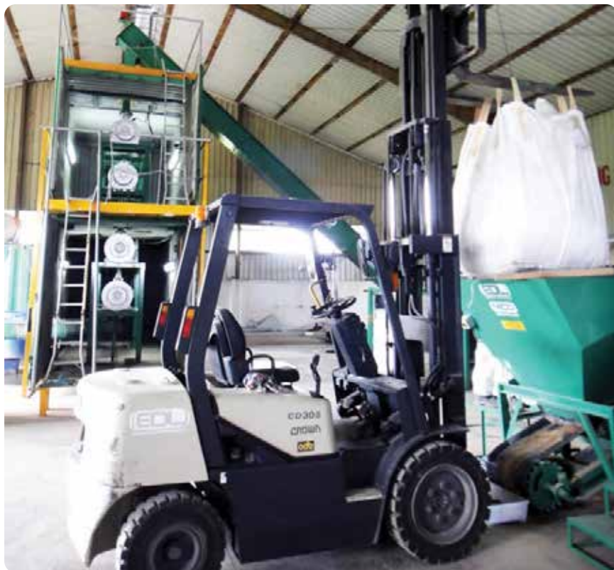
Figura 5. Molino de bolas de EDL tratando desechos de dioxinas de alta intensidad en Bien Hoa, Vietnam.
