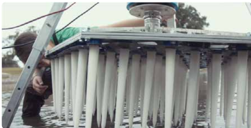
Figura 19. Sistema de extracción y remediación de polímeros absorbentes.
