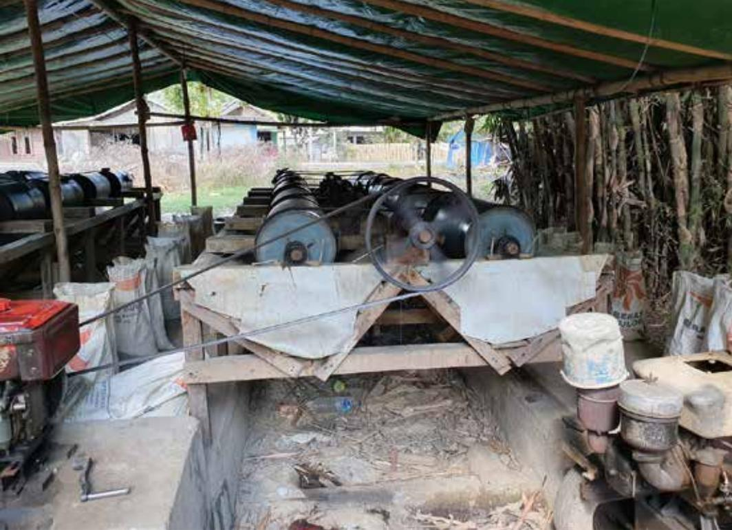
**Figura 1. Ejemplo de 'centro de procesamiento' para mineral de oro basado en la molienda de bolas en Indonesia. Foto: Lee Bell, IPEN**
