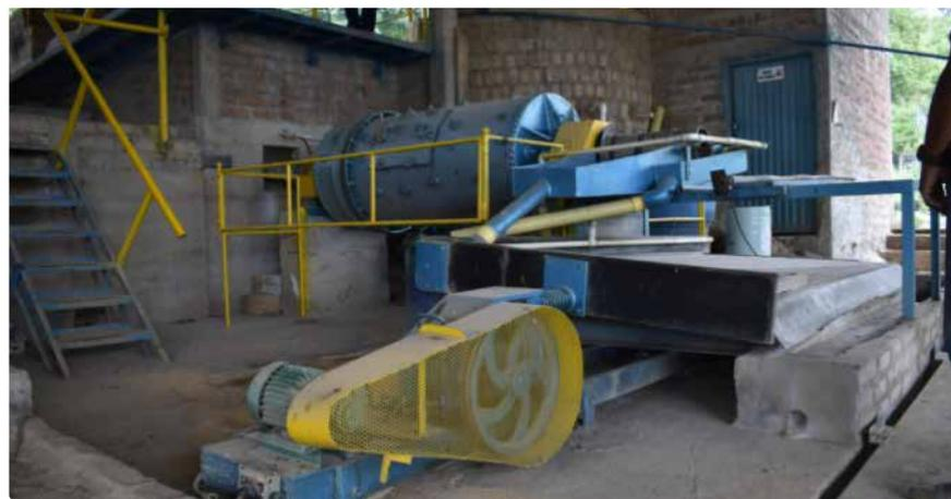
**Figura 14. Equipo nuevo para el procesamiento de mineral de oro libre de mercurio adquirido por la Cooperativa de las minas de Íquira.**
