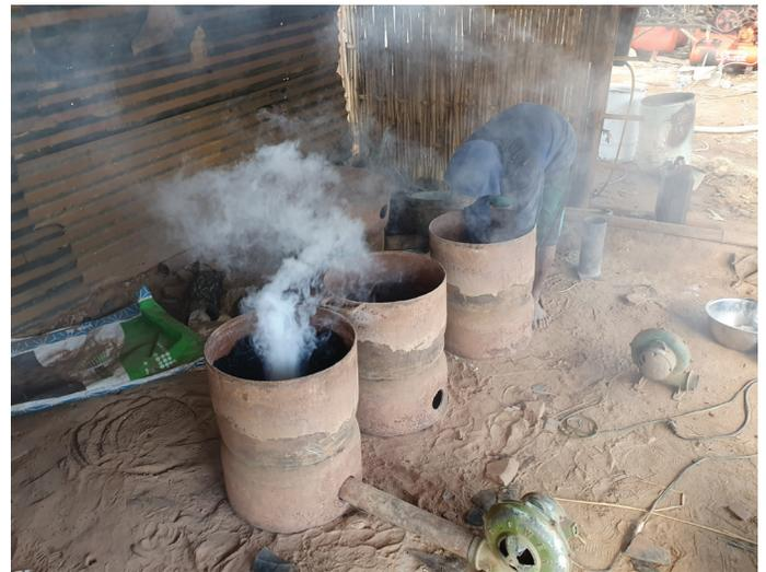
Figura 3. Planta de cianuración contaminada con mercurio en Indonesia. Deposito de desechos, liberaciones líquidas, emisiones provenientes de carbón activo tostado cargado con oro, mercurio y cianuro. Los residuos contaminados fueron regalados como material de construcción. Fuente: Lee Bell, IPEN
