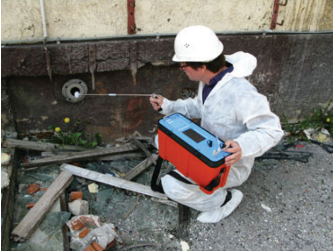
الصورة رقم 1: مثال عن محقق في موقع ملوث يستخدم جهاز نقال لتحليل بخار الزئبق
