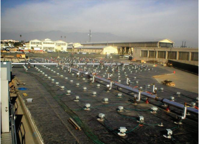
الصورة رقم 12: عملية امتزاز حراري في الموقع شاملة على تلوث للمركبات العضوية في الولايات المتحدة الأمريكية. المصدر: (Merly and Hube 2014)
