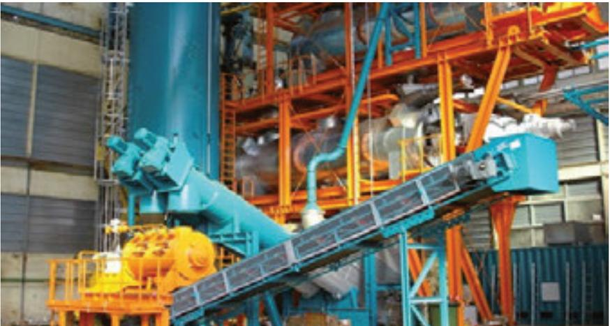
**Imagen 15. Unidad de destilación al vacío calentada indirectamente.**
