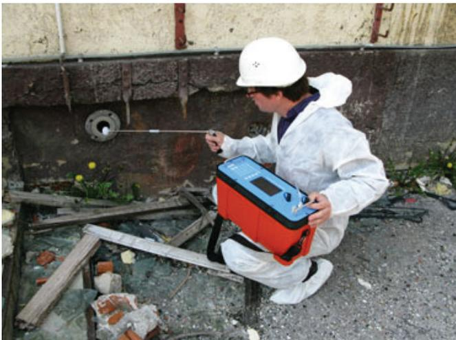
**Imagen 1. Ejemplo de un investigador de un sitio contaminado que utiliza un analizador portátil de vapores de mercurio.** Fuente: [www.mercury-instrumentsusa.com](http://www.mercury-instrumentsusa.com)
