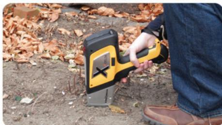
**Imagen 2. El analizador de fluorescencia de los rayos X portátil Olympus Delta con ejemplo de lectura de pantalla digital para metales en polímeros.** Fuente: [www.innovx.com](http://www.innovx.com)
