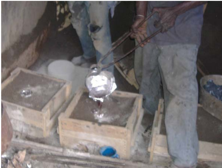
Photo 2 : coulage de l'aluminium
