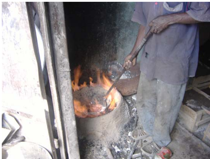
Photo 1 : fusion de l'aluminium
