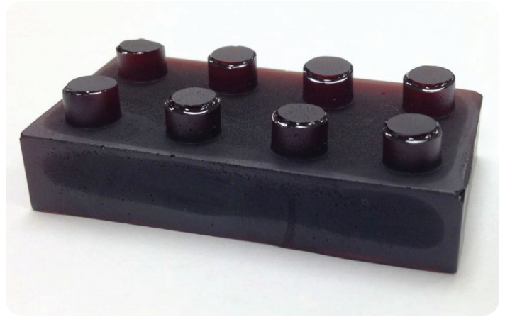
Figure 4. Un bloc de polysulfure de soufre-limonène. Source: Max Worthington, Flinders University
