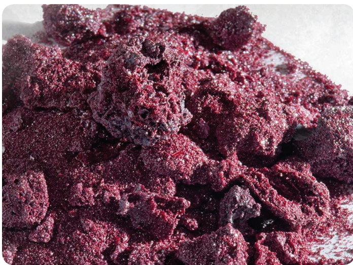
Figure 3. Mercure «retiré» par stabilisation du sulfure. Source: Bethlehem Apparatus Co. États-Unis d'Amérique
