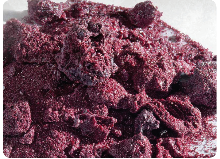
الشكل رقم 3. زئبق تمت إحالته إلى 'التقاعد' عن طريق تحقيق الاستقرار بالكبريتيد المصدر: Bethlehem Apparatus Co. U.S.A.
