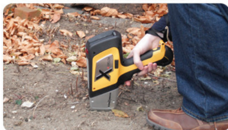
Рис 2. Портативный рентгеновский флуоресцентный анализатор Olympus Delta с примером показаний для содержания металлов в полимерах на экране. Источник: www.innovx.com
