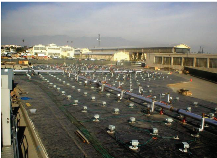
Рис 12. Полномасштабная термическая десорбция без выемки материала на участке, загрязненном органическими веществами в США. Источник: Merly and Hube (2014)
