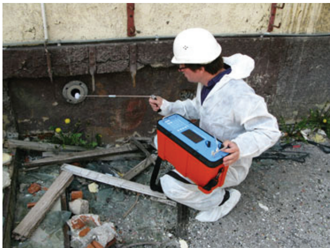
Рис 1: Пример изучения загрязненного участка с использованием портативного анализатора ртутных паров.. Источник: www.mercury-instrumentsusa.com
