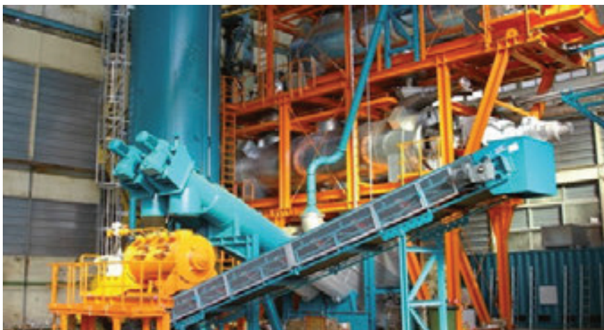
Рис 15. Установка для вакуумной возгонки с непрямым нагревом. Источник: econ industries GmbH цитируется в UNEP/ISWA 2015
