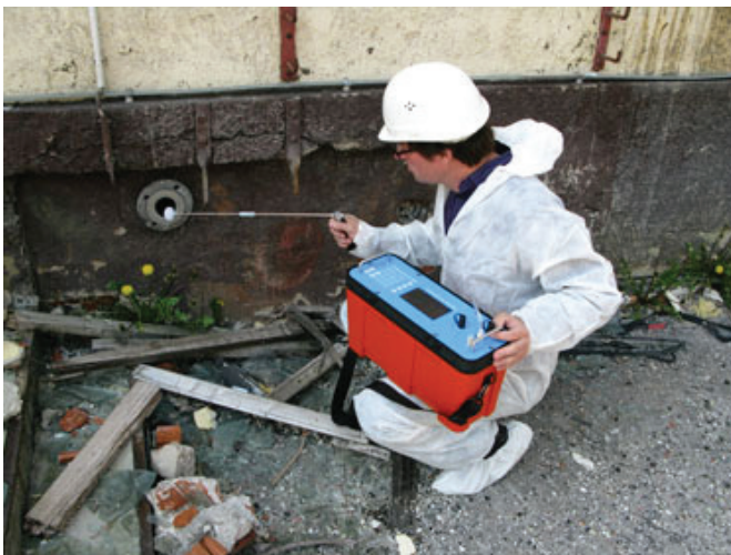
Figure 1. Exemple d'un enquêteur travaillant sur un site contaminé utilisant un analyseur de vapeur de mercure portable. Source: www.mercury-instrumentsusa.com
