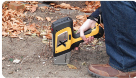
Figure 2. l'Analyseur Olympus Delta portable Fluorescence de rayons X avec écran de prise exemple de lecture par écran numérique pour les métaux contenant les polymères. Source: www.innovxx.com
