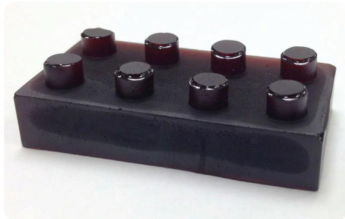
**Figura 4. Un bloque de polisulfuro de azufre y limoneno.** Fuente: Max Worthington, , Universidad de Flinders
