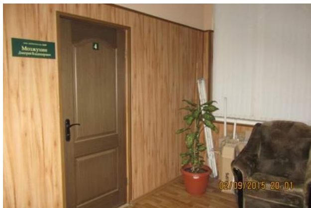
Рисунок 6. Складирование использованных ртутьсодержащих ламп без упаковки в коридоре образовательного учреждения, г.Дзержинск, 2015г.)
